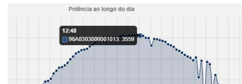
Indicativo da potência instantânea injetada na rede elétrica em um determinado horário em W (Web).
