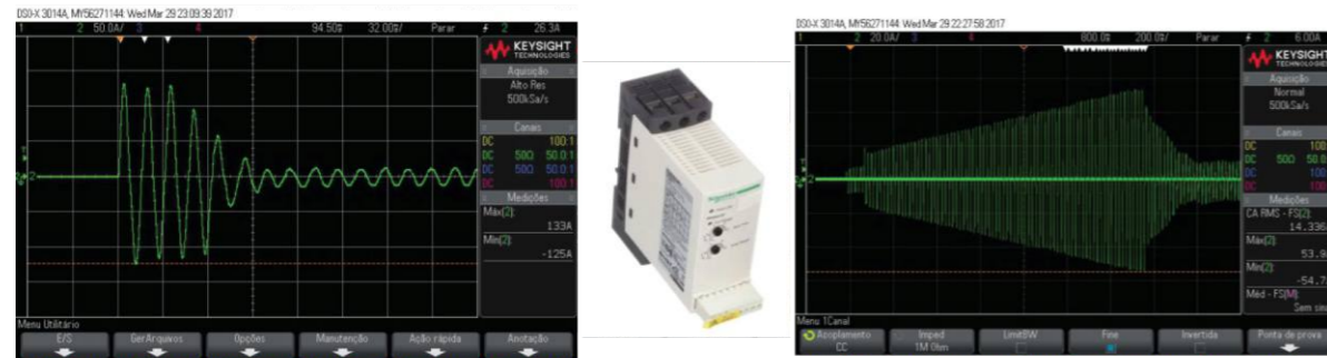
Partida de um motor weg monofásico 3CVs utilizando soft-starter (esquerda); Partida de um motor weg monofásico 3CVs (direita); Soft-starter Schneider ATS01N125FT (centro).
