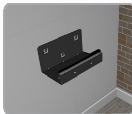
Fixar trava no suporte de parede com os parafusos M4 x 10 (um em cada lateral e dois no centro)
