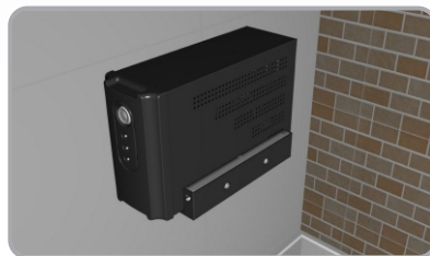
Antes de fixar o Nobreak NHS Mini insira nas laterais da trava os isolantes e faça o ajuste apertando os parafusos centrais.
