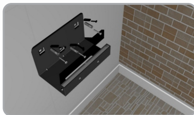
Fixação do suporte na parede
