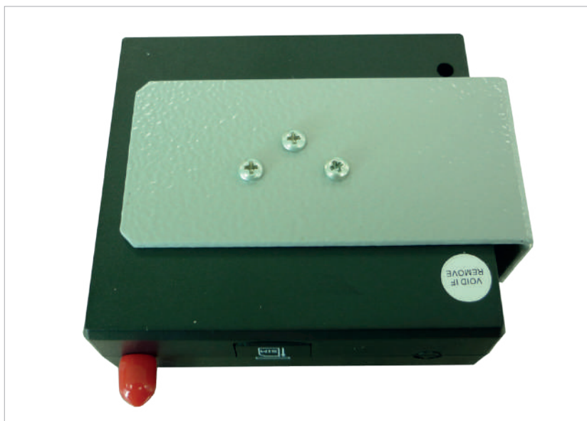
Figura 06: Fixação do suporte no GPRS
