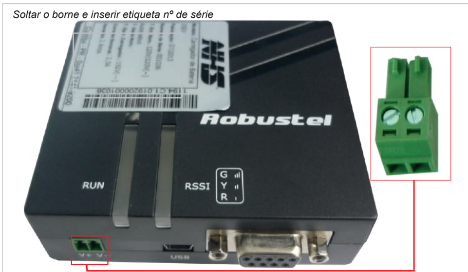
Figura 02: GPRS sem o borne e com etiqueta nº de série
