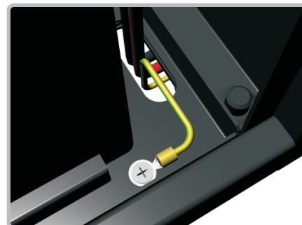
Fixar o terminal olhal no parafuso da base do módulo (desparafusar e fixá-lo novamente).
